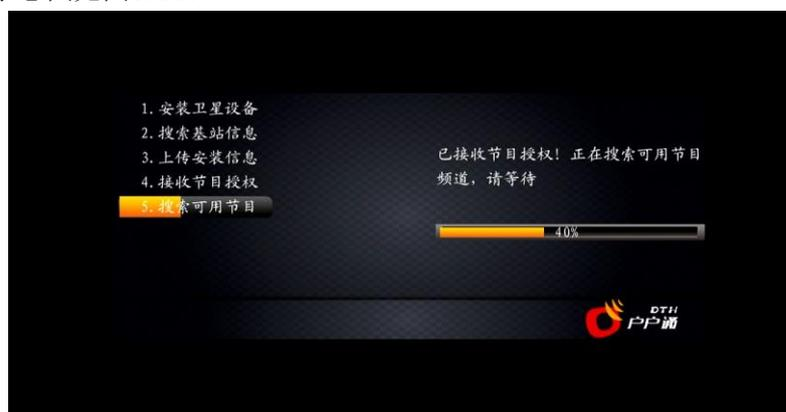
图 C. 50 安装过程中可用节目搜索示意图
