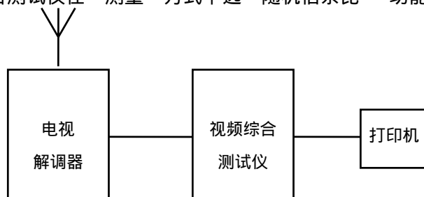
图 8 视频测量原理框图
