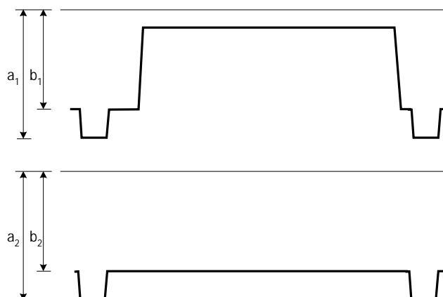
图 23 解调后用示波器测量的消隐电平变化
