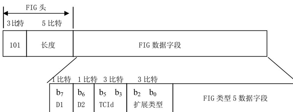
图7 FIG 类型 5 数据字段的结构
