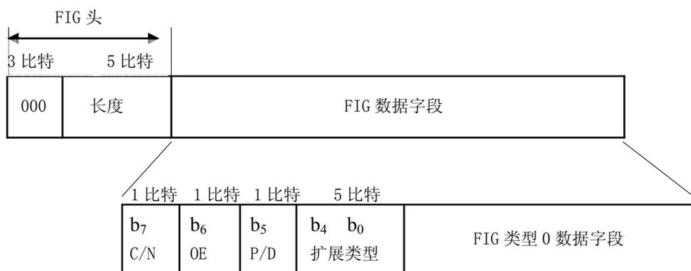
图4 FIG 类型 0 数据字段的结构
