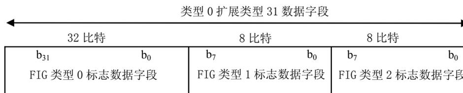
图59 FIG 重新定向数据字段的结构
