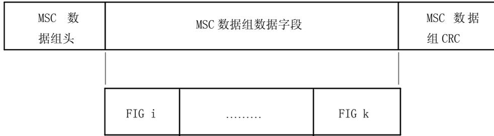
图15 传输 FIGs 的 MSC 数据组结构
