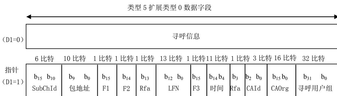
图69 寻呼数据字段的结构
