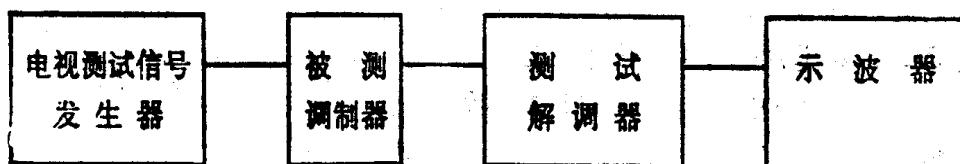
图9 视频钳位能力测量
