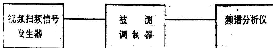
图11 邻频抑制测量
